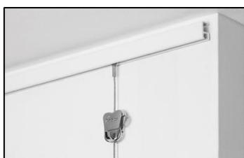
Die Minirail ist eine schmale, sehr elegant und dezente Bilderschiene. Trotz ihrer geringen Grösse bietet die Minirail eine Tragkraft von bis zu 25 kg pro Meter. Die Montage der Schiene ist mit den speziell entwickelten Clipschrauben leicht und schnell.
